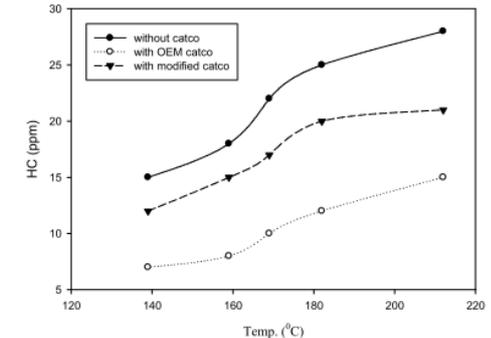
**Fig. 7 Temp. V<sub>s</sub> HC**
